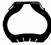
FALTA DE PRESSÃO
